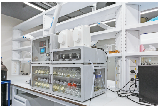
高智化学自主研发的高通量智能多肽合成仪。
